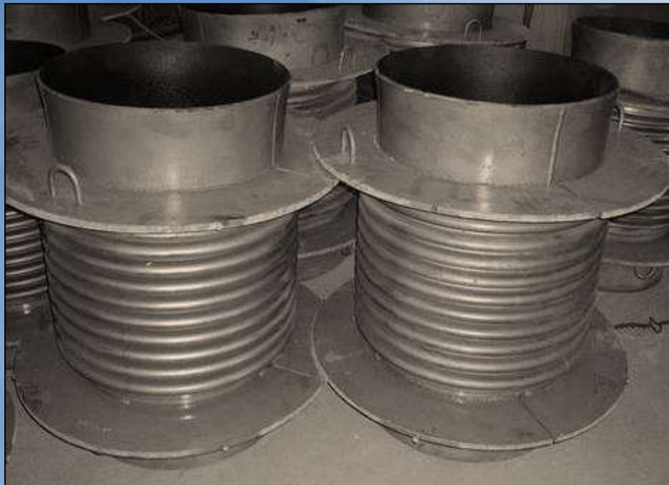
Компенсаторы перед монтажом. 1988г.
